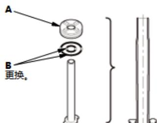
4. 检查供油管法兰板和供油管法兰是否磨损或损坏，如有必要，进行更换。
